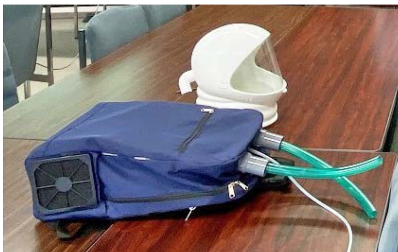
マスクとバックパック(ポンプ、フィルタ、各種センサー、バッテリーなどを収納)
